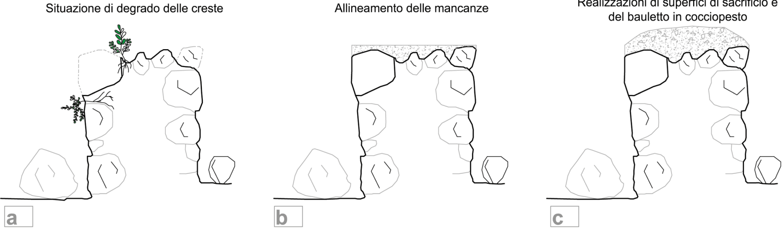
Fig. 1 – Intervento di protezione delle creste murarie, con creazione del c.d. “bauletto” in cocciopesto - Elaborazione CAD a cura di: Cons. BB.AA. Angela Alfieri Il “bauletto” costituisce uno strato di sacrificio posto a protezione della sottostante muratura, quindi soggetto alle intemperie in modo diretto. Il lato superiore di tale strato non dovrà avere superficie piana, ma essere modellato a “schiena d’asino” proprio per impedire l’infiltrazione di acqua piovana. È sempre necessario garantire una lettura netta dell’integrazione rispetto alla muratura originaria ricorrendo a sopraquadro o sottoquadro, oppure adottando una colorazione distinguibile (ad es. tinta più chiara).
